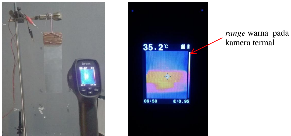
Gambar 4.1 Range warna pada kamera termal FLIR TG165
