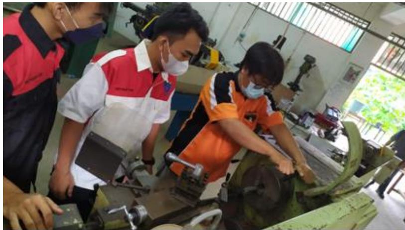
Gambar 2. Praktikum memasang spesimen pada mesin bubut
