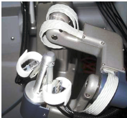
Abb. 6 c. Kutanes Display montiert auf eine da Vinci Steuerung [17]. Der Sensor aus Abbildung 6 a gibt die Kraft vor, welche in fünf Stufen am taktilen Modul ausgegeben wird.
