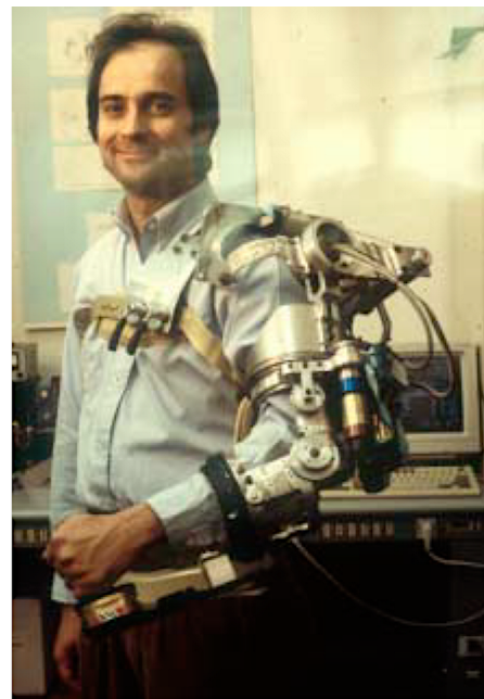
Abb. 4. Professor Massimo Bergamasco aus der Scuola Superiore di Studi Universitari in Pisa, Italien und sein Prototyp eines am Arm befestigten Exoskeletts als kinästhetisches Gerät in den Anfängen der Forschung [15].
