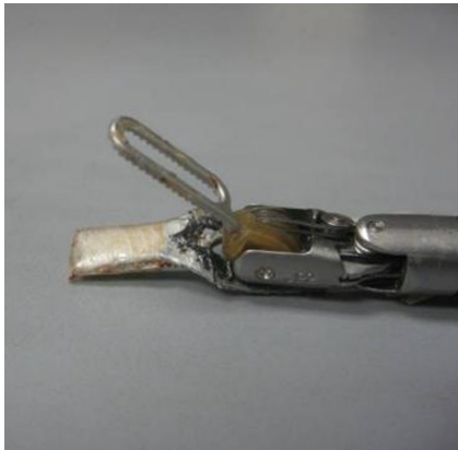
Abb. 6 a. Greifer eines da Vinci Systems mit integriertem, wasserdichten Sensor [17].
