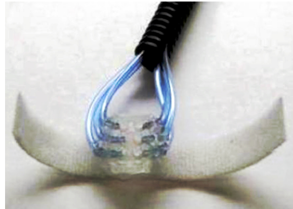
Abb. 6 b. Kutanes Ausgabegerät: taktiler, pneumatisches Ballon-Feedbacksystem [17].
