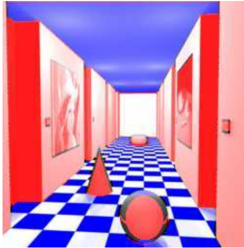
FIG. 6.8 – Classification des pixels de la carte de disparité : les pixels bleus appartiennent à des surfaces horizontales et les pixels rouges appartiennent à des objets verticaux.
