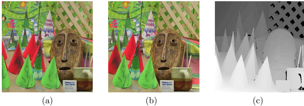
FIG. 2.6 – Couple d'images Cones. (a) Image gauche. (b) Image droite. (c) Carte de disparité.
