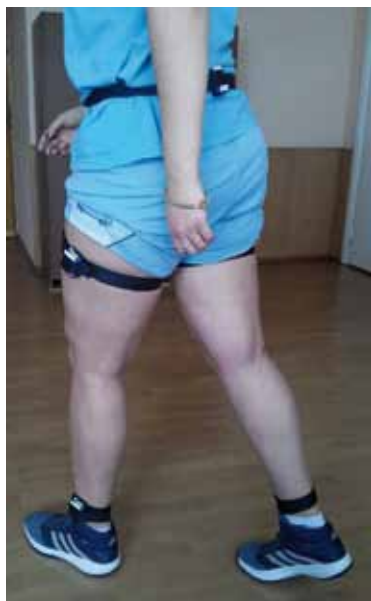
Рис. Исследование биомеханики походки с помощью безплатформенных инерционных сенсоров «Траст-М» (ООО «Неврокор»)
