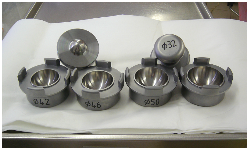
Рис. 2. Формы для изготовления спейсера вертлужной впадины
