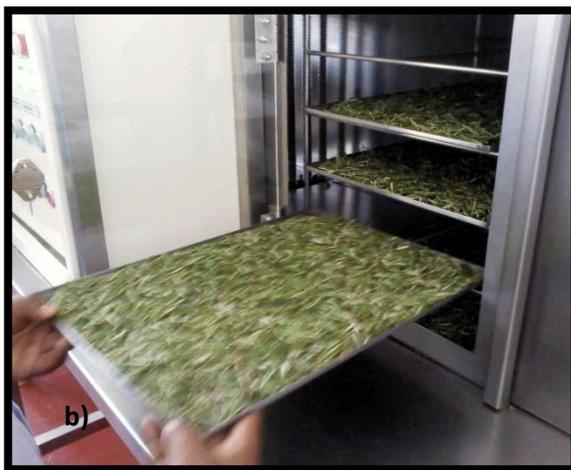
Introducción de bandeja a secador de bandejas (b).
