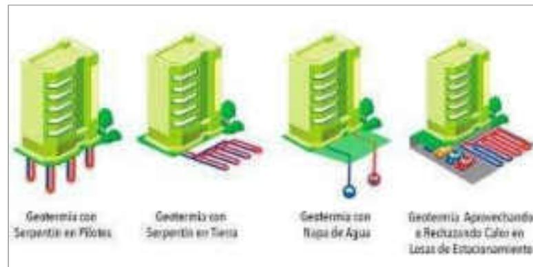
Figura 33. Esquema Geotermia
