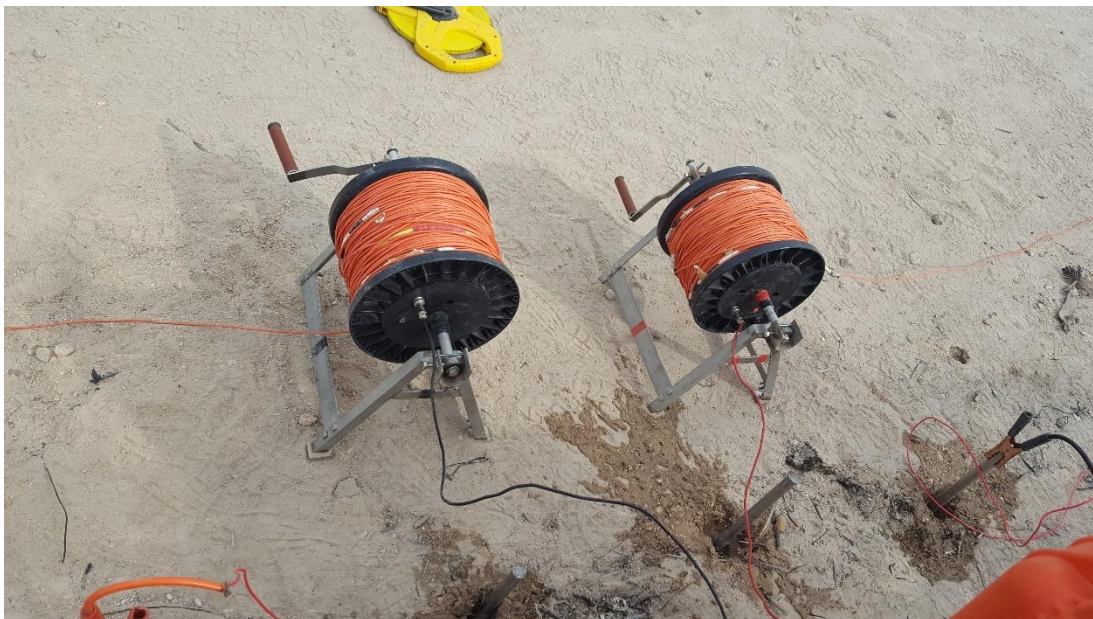
Foto n° 37: Cable requerido y conectado a las estacas para emitir las descargas.
