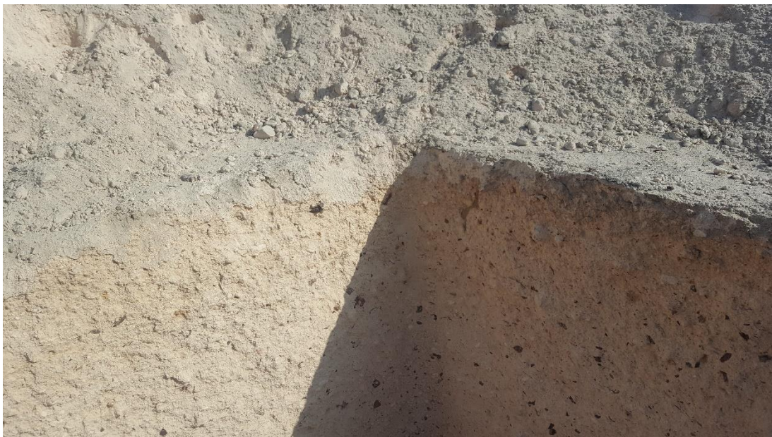
Foto n° 05: Vista del perfil de la calicata realizada.
