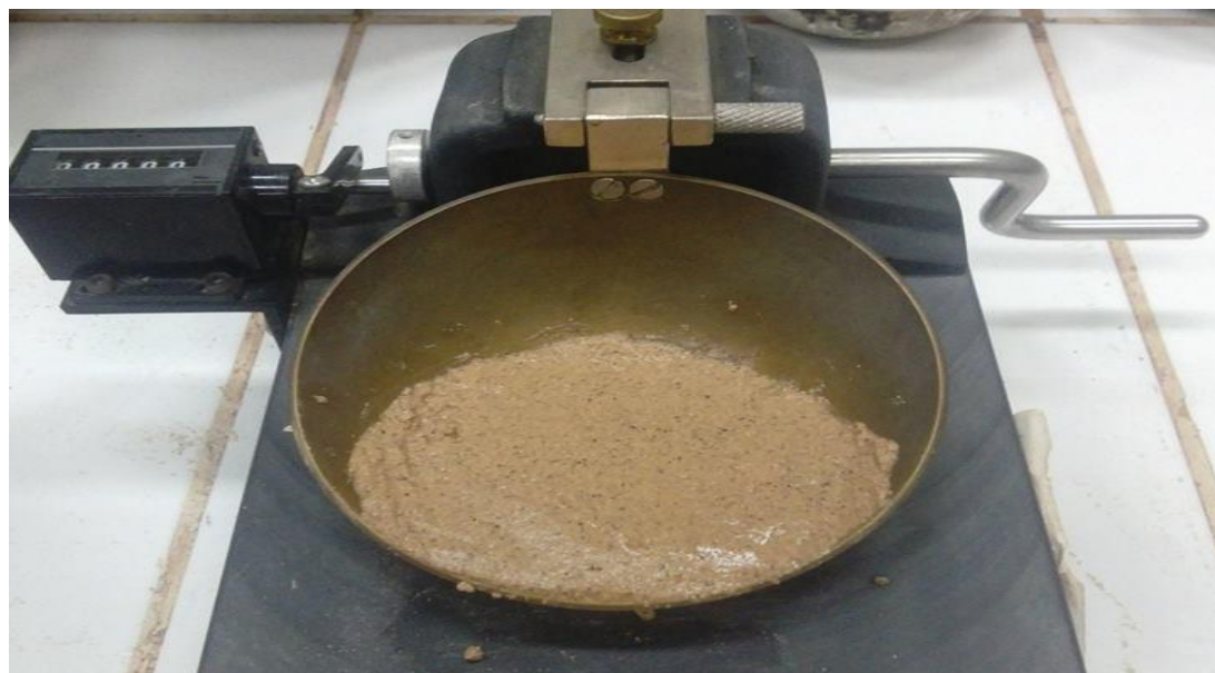
Foto n° 18: Equipo de laboratorio copa de Casagrande realizando el ensayo.
