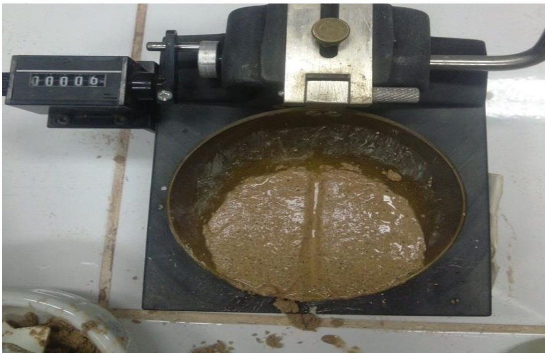
Foto n° 19: Equipo de laboratorio copa de Casagrande realizando el ensayo.
