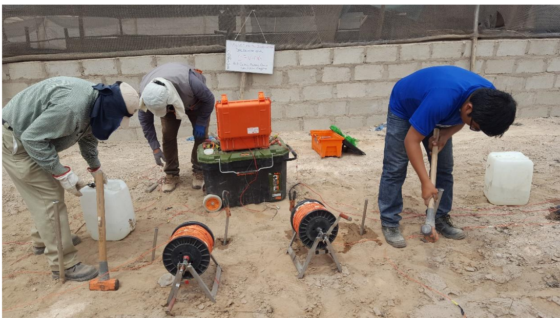
Foto n° 34: Realizando el clavado de las estacas con las herramientas requeridas.
