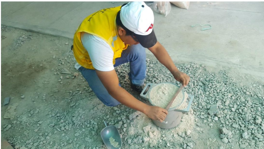
Foto n° 09: Determinar relación peso volumen.
