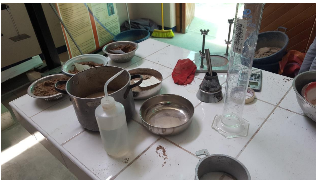
Foto n° 16: Equipo de laboratorio para realizar el ensayo de limite líquido.
