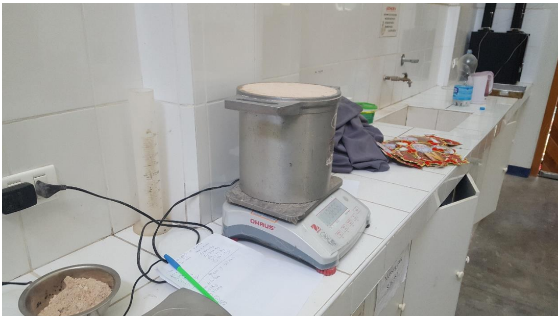
Foto n° 11: Pesado de la muestra determinar relación peso volumen.
