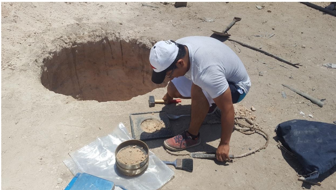
Foto n° 23: Realizando el ensayo de densidad in-situ.
