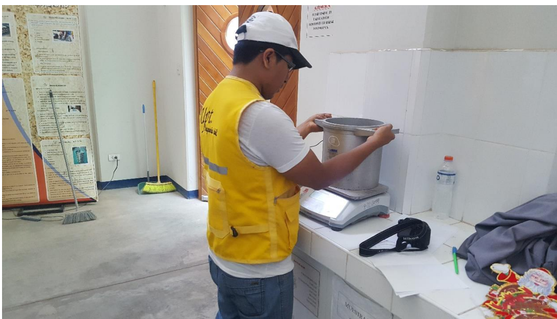
Foto n° 10: Pesado de la tara para determinar relación peso volumen.
