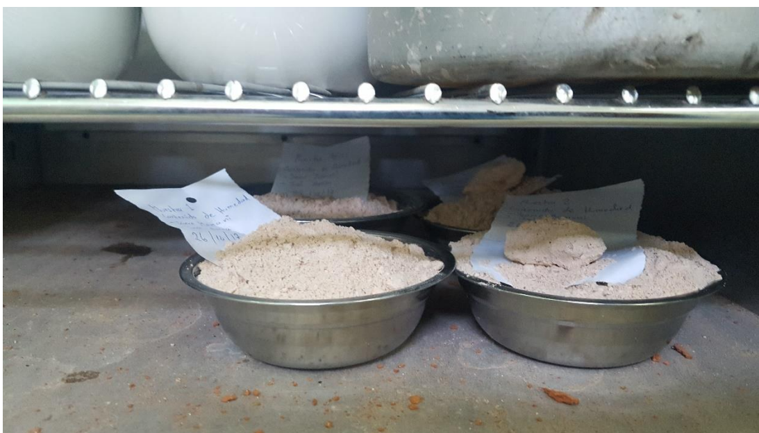
Foto n° 08: Colocación al horno para determinar el contenido de humedad de la muestra.
