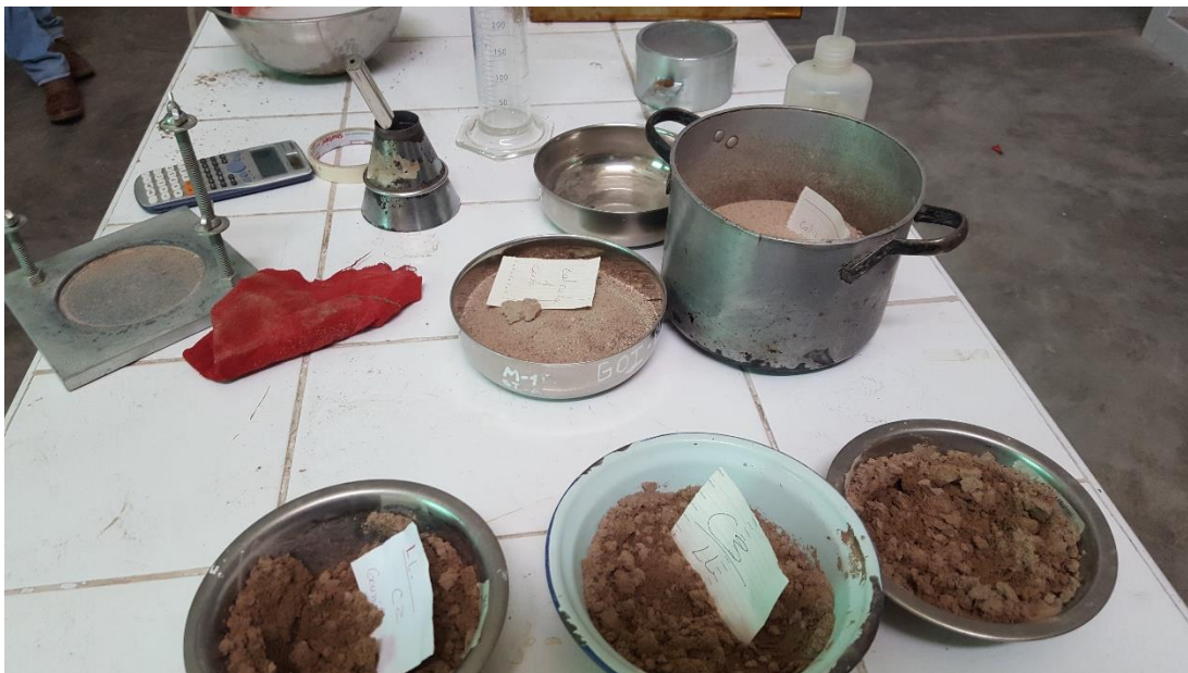
Foto n° 15: Preparando muestra para realizar el ensayo de plasticidad
