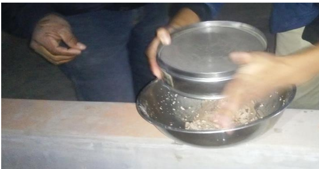
Foto n° 14: Lavado de la muestra retenida en la malla #200.
