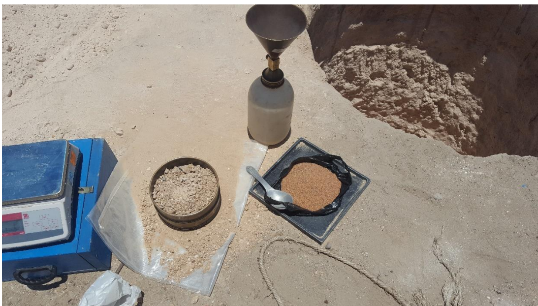
Foto n° 24: Realizando el ensayo de densidad in-situ.
