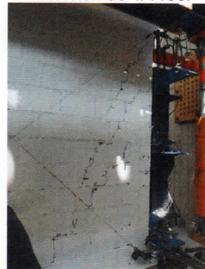
Foto 51. Continuación de grietas diagonales en el lado Oeste de la cara Norte para una distorsión de 1/800.
