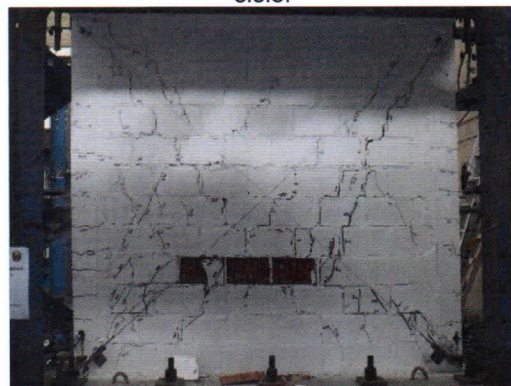
Foto 29. Desprendimiento de otra cara de un ladrillo en la zona central Este de la cara Norte para una distorsión de 1/200 en el 2° ciclo.
