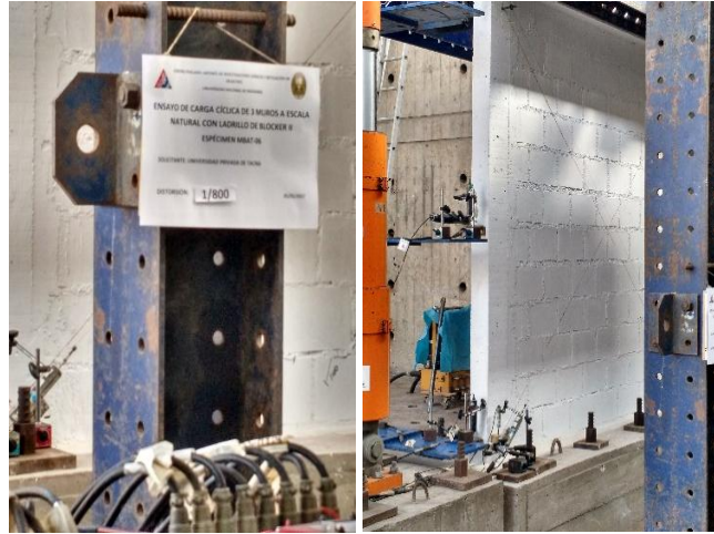
Fotografía N°1. Espécimen MBAT-06 Preparado para Empezar con el Ensayo.
