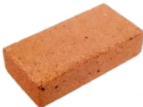
Figura N° 2.7. Unidad de albañilería artesanal
