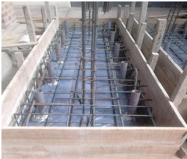
Figura N°3.2. Colocación de columnas y 4 anclajes para realizar el traslado y ubicación del muro a la máquina para realizar el ensayo
