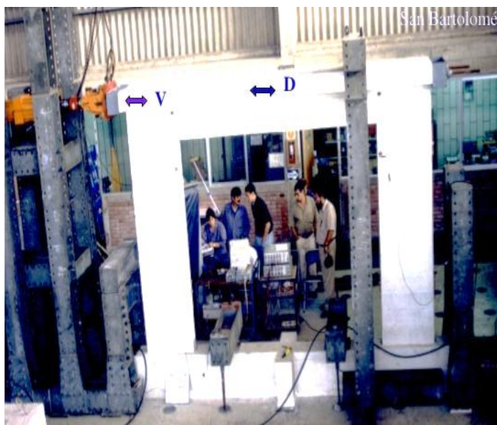
Figura N°2.20. Ensayo de carga lateral cíclica en el laboratorio de Estructuras de la PUCP.
