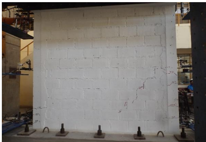
Figura N°5.3. Aparición de grietas diagonales en el mortero en el lado Este de las caras Norte y Sur a una distorsión 1/1500.
