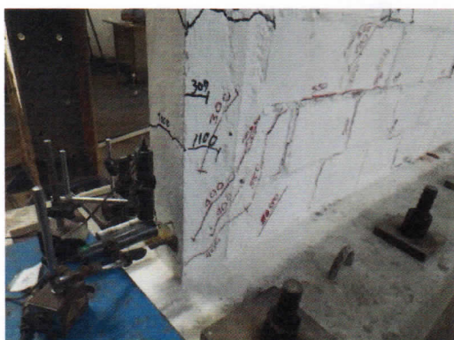
Foto 78. Formación de grietas en el talón Oeste de la cara Sur y en la parte inferior de la columna Oeste para una distorsión de 1/300.
