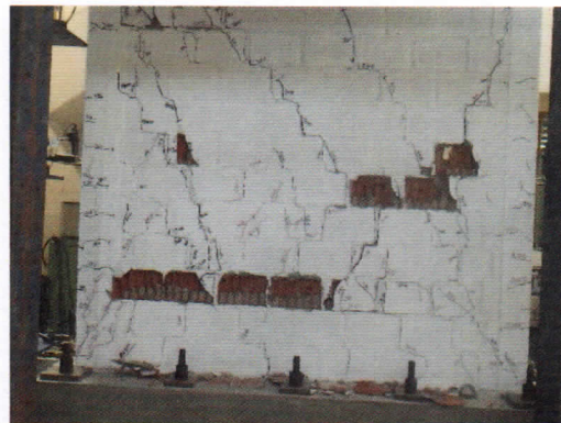
Foto 97. Desprendimiento de dos ladrillos en la parte inferior central de la cara Sur para una distorsión de 1/150.
