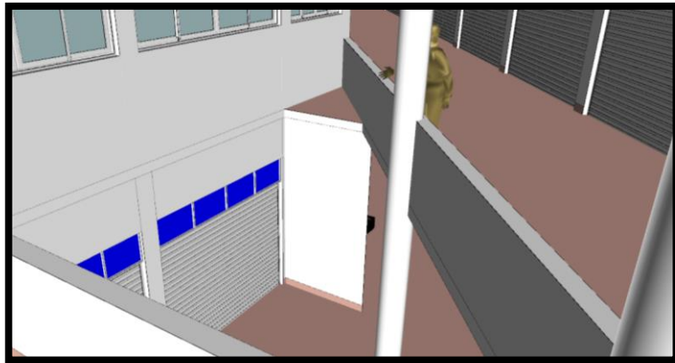
Figura 46. Incompatibilidad entre el 1er nivel y 2do nivel en planos de arquitectura
