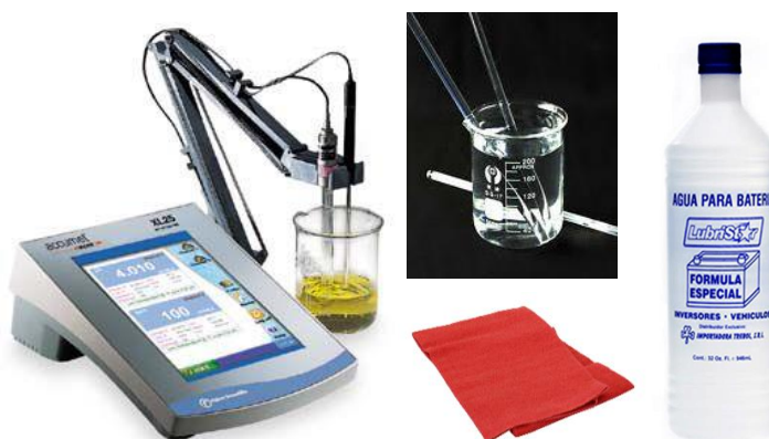
Figura 51. Instrumentos del ensayo de determinación de cloruros en el concreto
