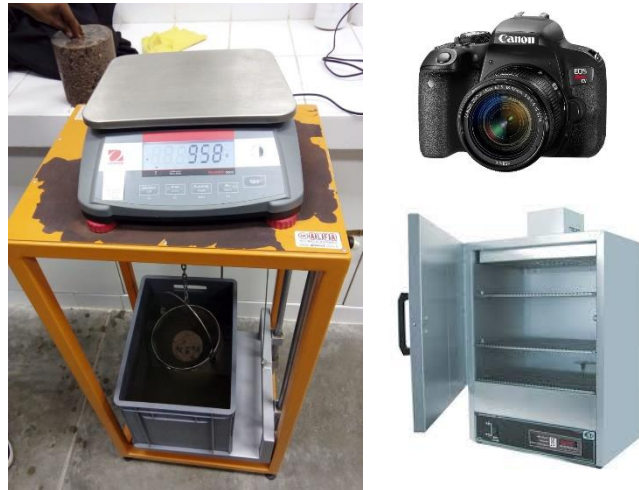
Figura 48. Instrumentos del ensayo de densidad, absorción y porosidad en el concreto
