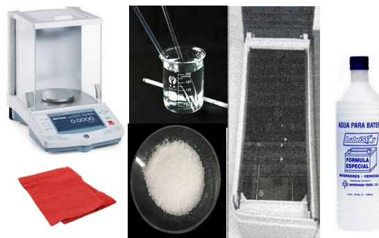
Figura 58. Instrumentos del ensayo de determinación de sulfatos en el agua
