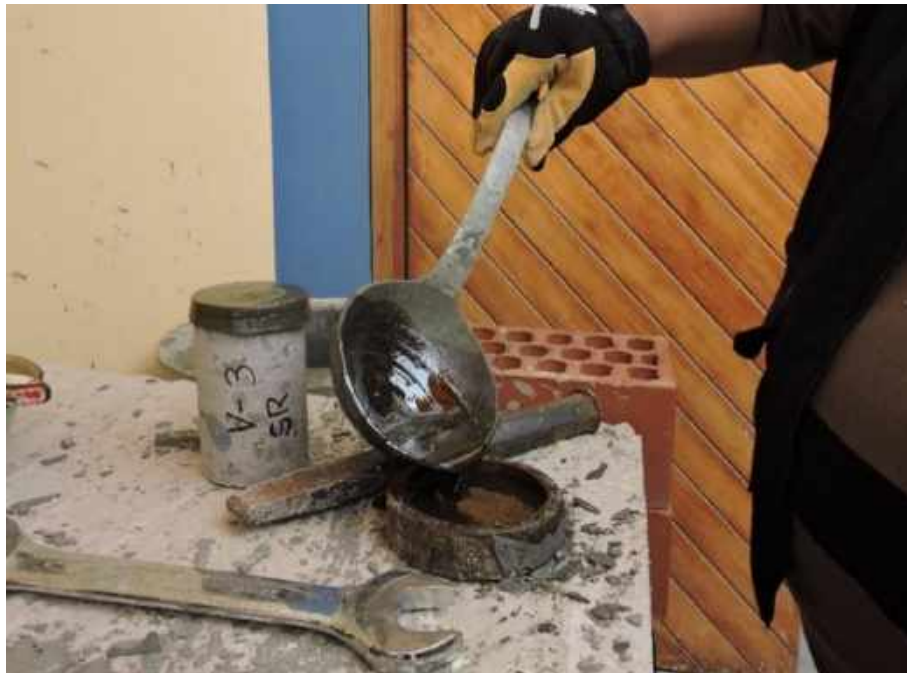
Fotografía 5. Refrentado capping, colocación de mortero de azufre en plato de refrenado
