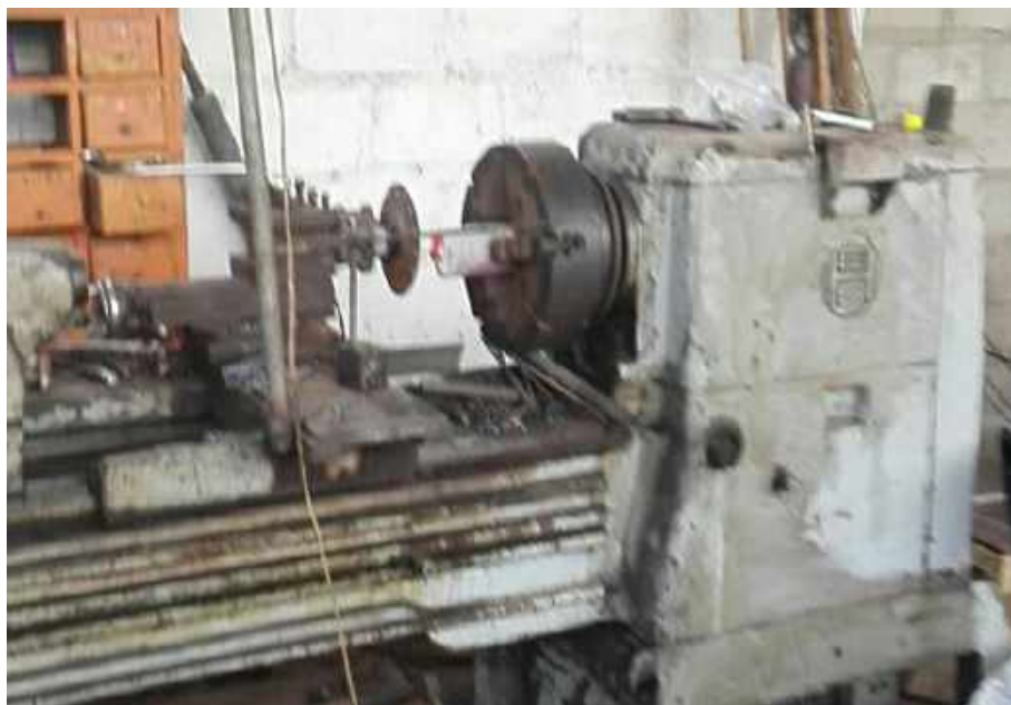
Fotografía 4. Perfilado de diamantinas de concreto
