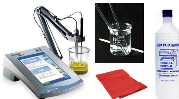
Figura 54. Instrumentos del ensayo de determinación de cloruros en agregados
