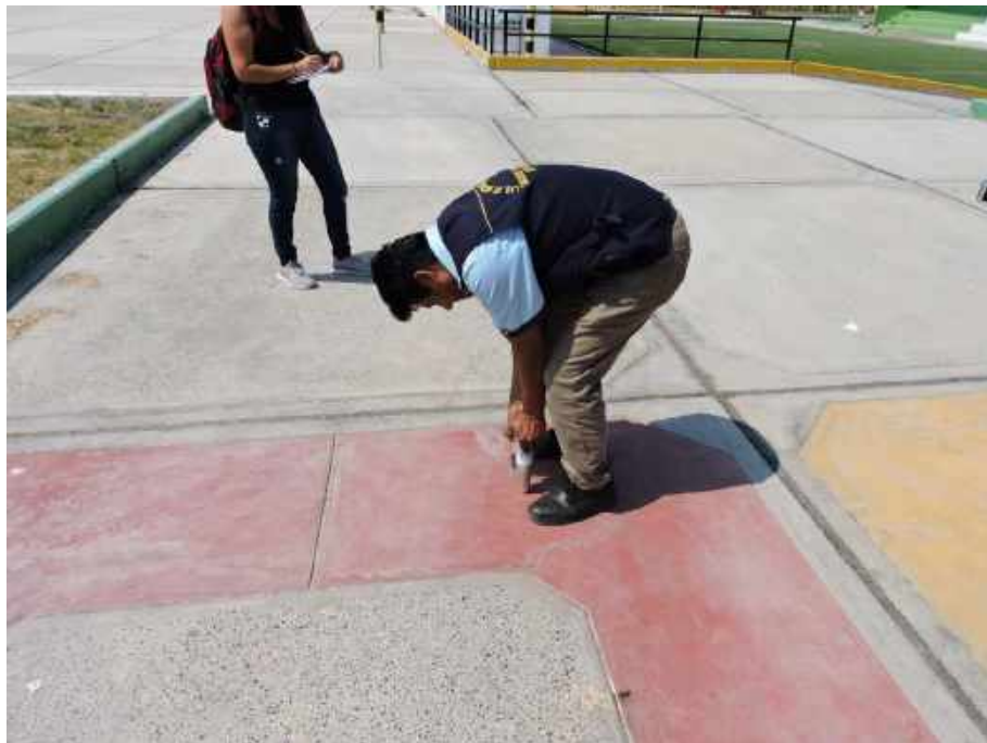
Fotografía 16. Resistencia de veredas en zona de losa deportiva utilizando esclerómetro
