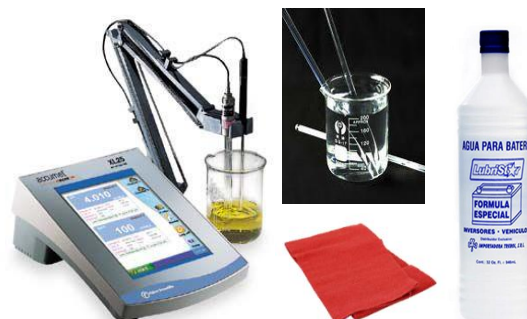
Figura 57. Instrumentos del ensayo de determinación de cloruros en el agua
