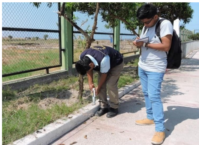
Figura 28. Ensayo de resistencia a compresión mediante esclerómetro
