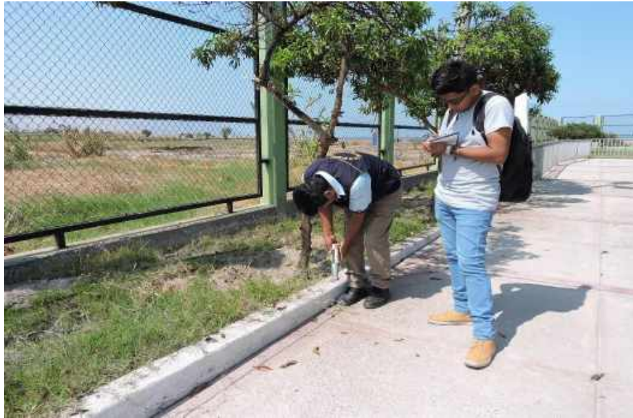
Fotografía 12. Resistencia de sardineles de la zona de la piscina utilizando el esclerómetro
