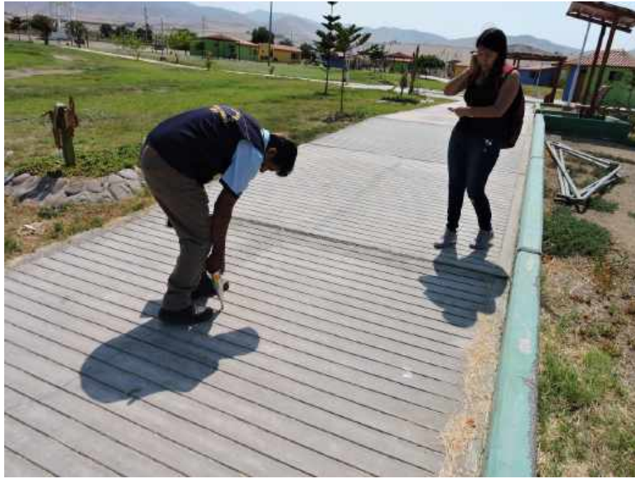
Fotografía 15. Resistencia de veredas en zona de losa deportiva utilizando esclerómetro
