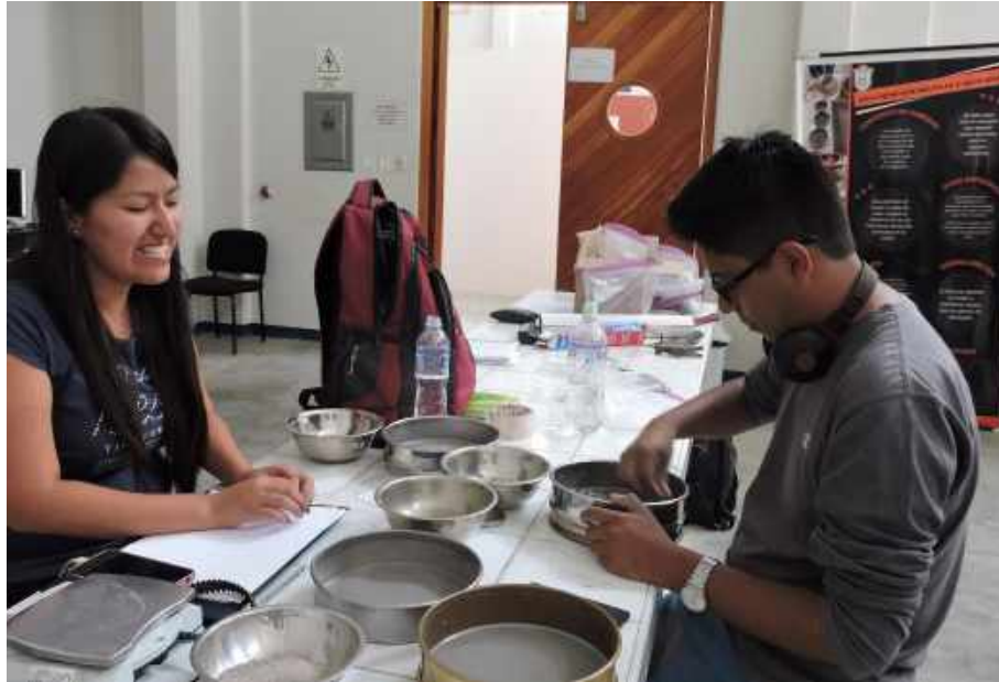
Fotografía 24. Separación de los componentes del concreto para ensayos químicos
