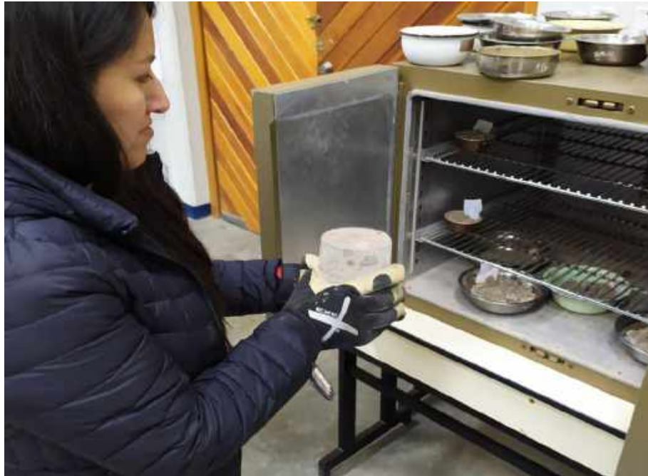
Fotografía 17. Porosidad del concreto, diamantinas de concreto puestas al horno
