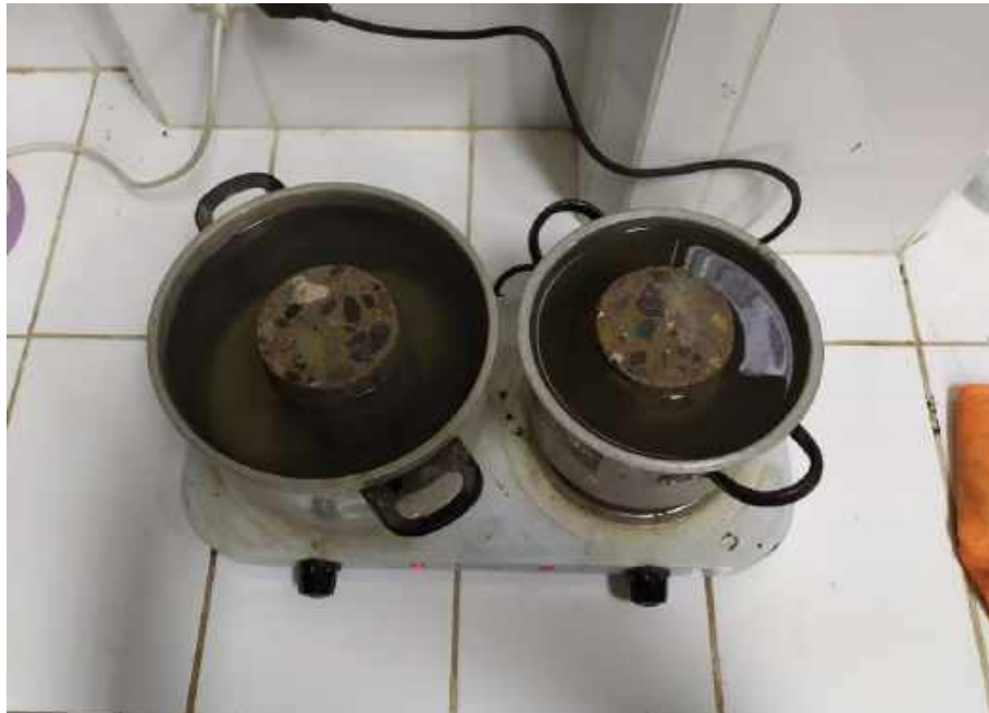
Fotografía 19. Absorción del concreto, muestras sumergidas en agua en ebullición
