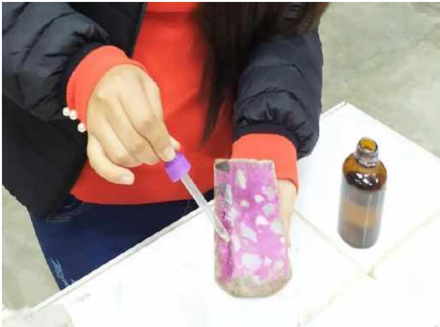
Fotografía 22. Profundidad de Carbonatación, aplicación de fenoftaleina en la parte interior del testigo de concreto
