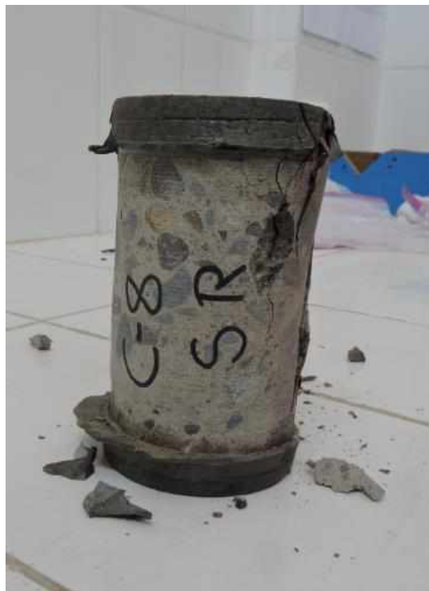
Fotografía 10. Dirección de rotura de diamantina M-01
