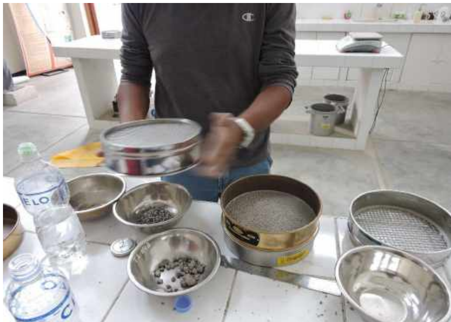
Fotografía 23. Separación de los componentes del concreto para ensayos químicos
