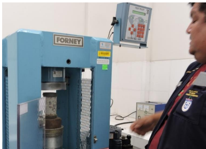
Figura 29. Ensayo de resistencia a compresión del concreto
