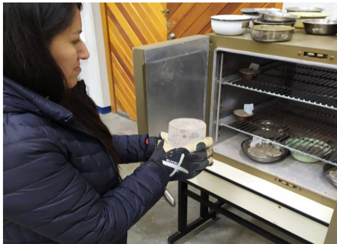
Figura 30. Ensayo de densidad, absorción y porosidad del concreto
