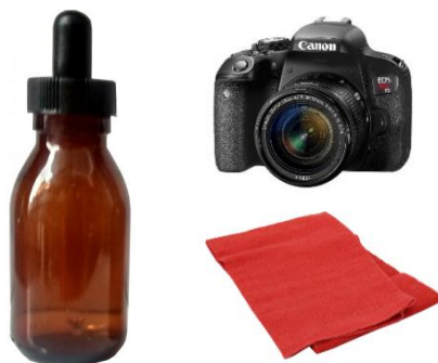
Figura 49. Instrumentos del ensayo de profundidad de carbonatación en el concreto
