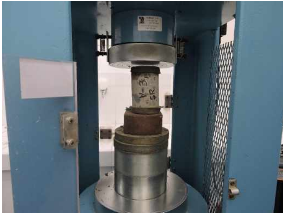
Fotografía 7. Resistencia a compresión de diamantinas de concreto M-03
