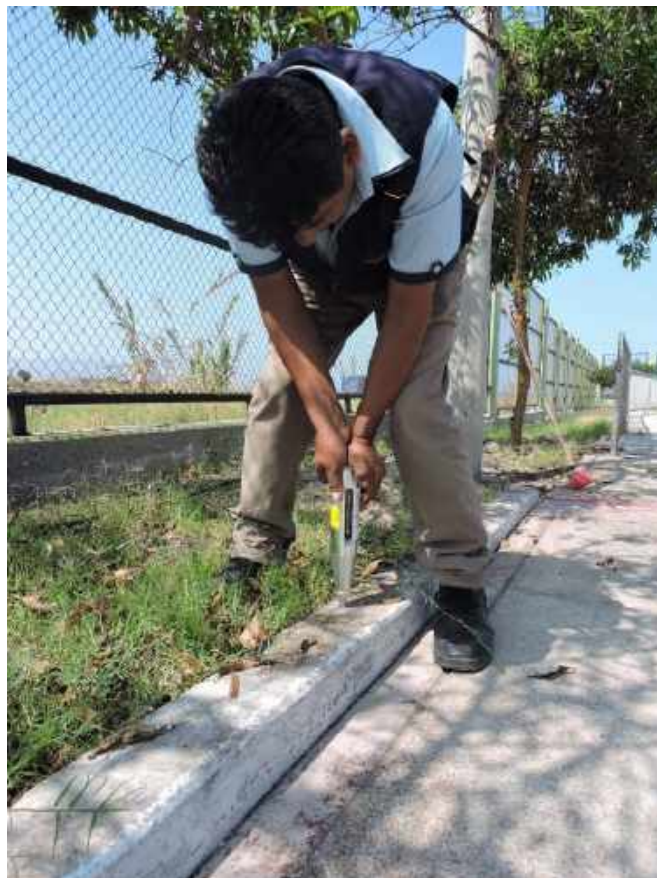
Fotografía 11. Resistencia de sardineles de la zona de la piscina utilizando el esclerómetro
