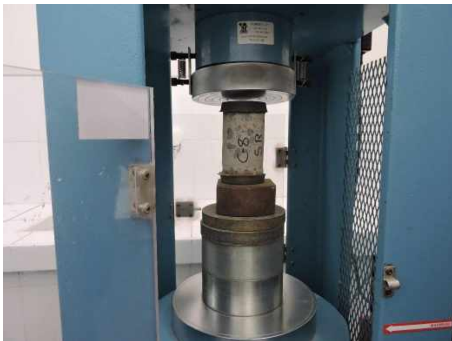
Fotografía 8. Resistencia a compresión de diamantina de concreto M-01
