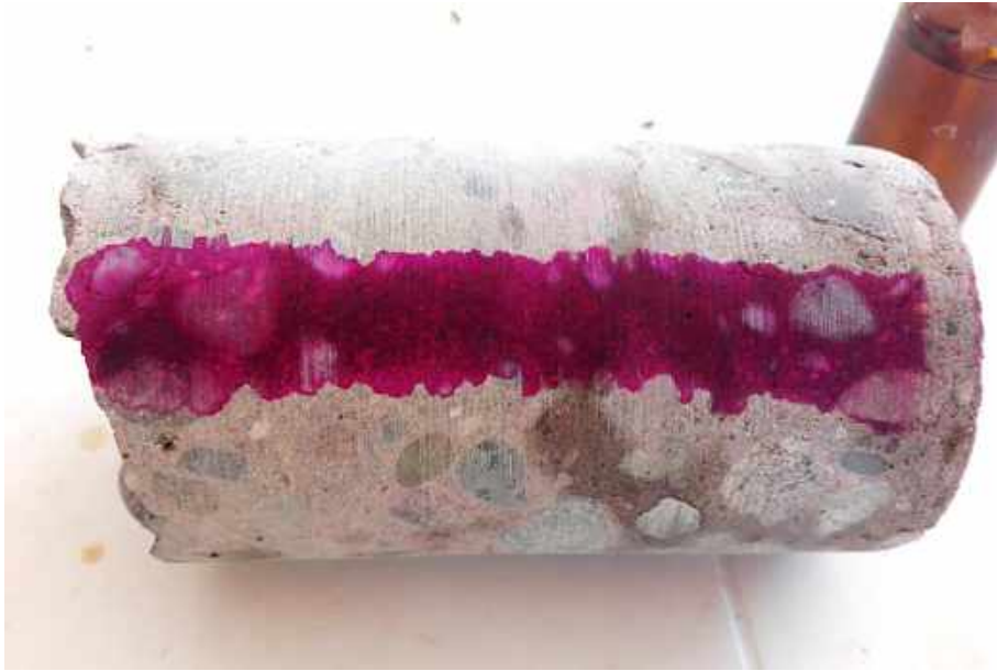
Fotografía 21. Profundidad de Carbonatación, aplicación de fenoftaleina en la parte exterior del testigo de concreto
