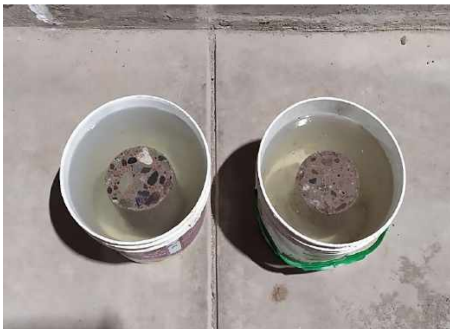
Fotografía 18. Absorción del concreto, muestras sumergidas en agua
