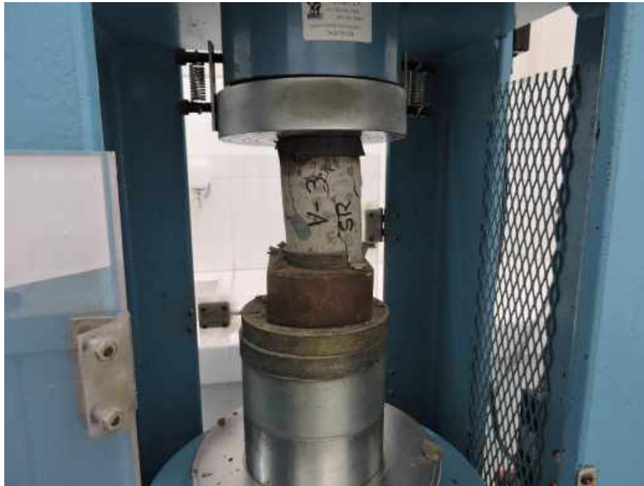
Fotografía 9. Dirección de rotura de diamantina de concreto M-03
