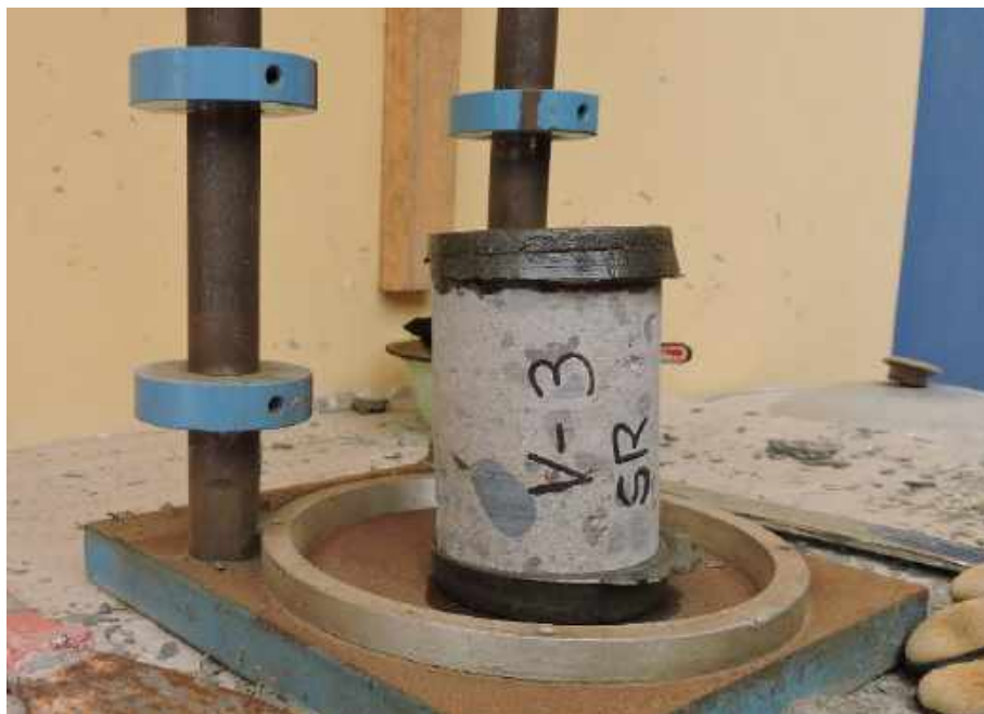
Fotografía 6. Refrentado capping, bases superior e inferior de mortero de azufre en testigo de concreto
