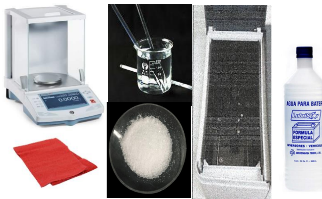
Figura 55. Instrumentos del ensayo de determinación de sulfatos en agregados
