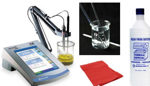
Figura 50. Instrumentos del ensayo de determinación de pH en el concreto
