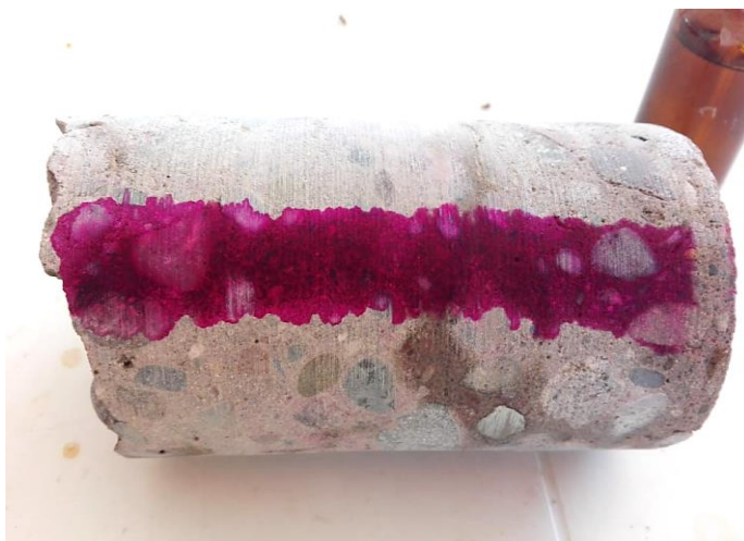
Figura 31. Ensayo de profundidad de carbonatación en el concreto
