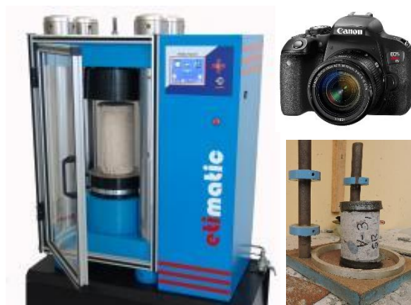
Figura 46. Instrumentos del ensayo de Resistencia a compresión de testigos de concreto
