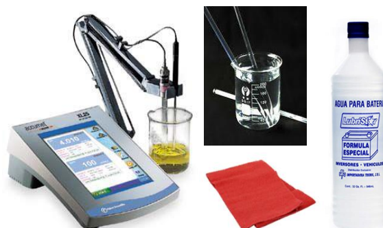
Figura 56. Instrumentos del ensayo de determinación de pH en el agua
