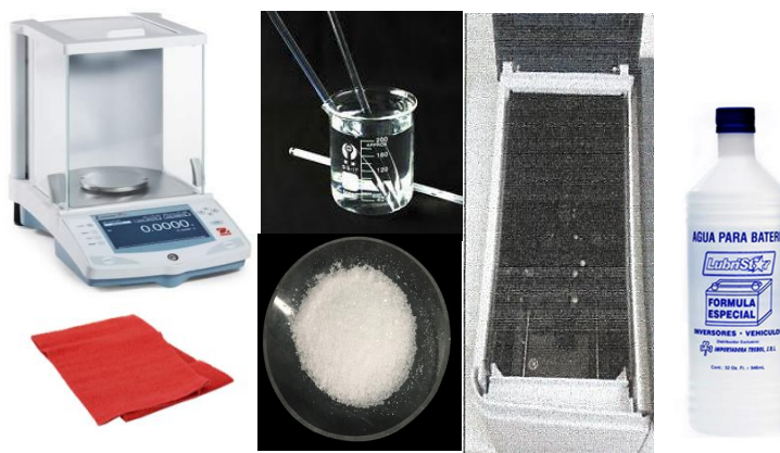
Figura 52. Instrumentos del ensayo de determinación de sulfatos en el concreto en el concreto
