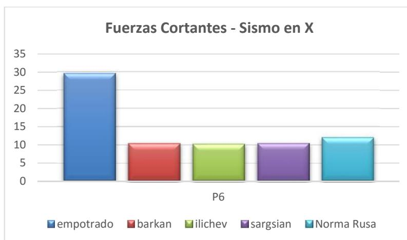
Figura 54: Fuerzas Cortante P6 - Análisis dinámico – Sismo X
