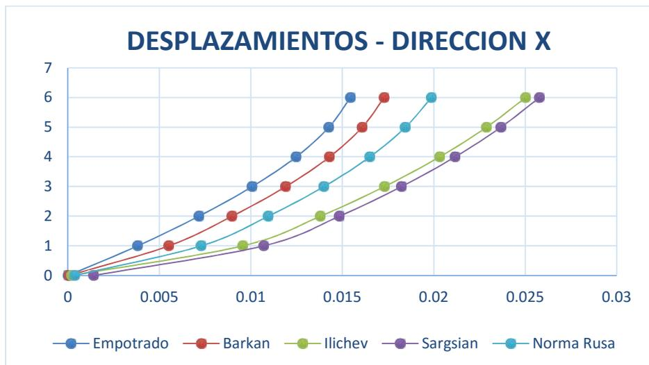
Figura 42: Desplazamientos Sismo X - Análisis dinámico
