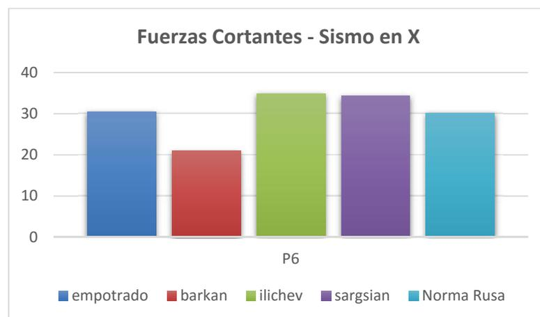
Figura 37: Fuerza Cortante Placa P-6 Análisis Estático Sismo X
