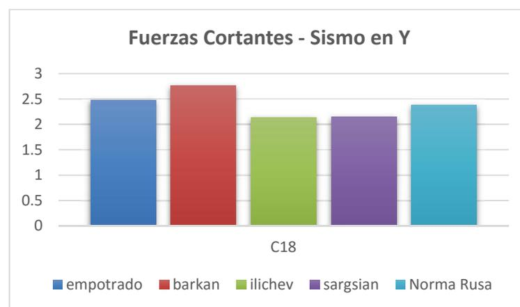
Figura 48: Fuerzas Cortante C18 - Análisis dinámico -- Sismo Y
