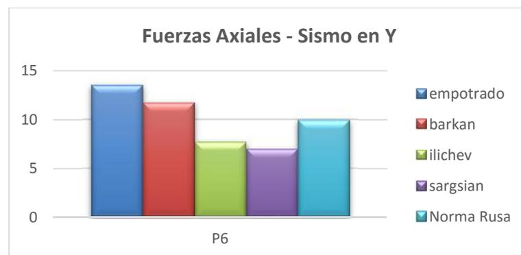
Figura 56: Fuerzas axiales P6 - Análisis dinámico – Sismo Y
