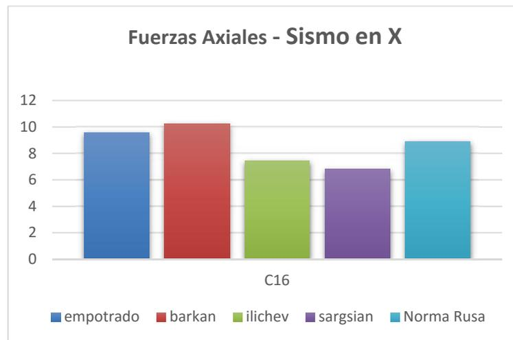
Figura 30: Fuerza axial columna C16 Análisis Estático Sismo X
