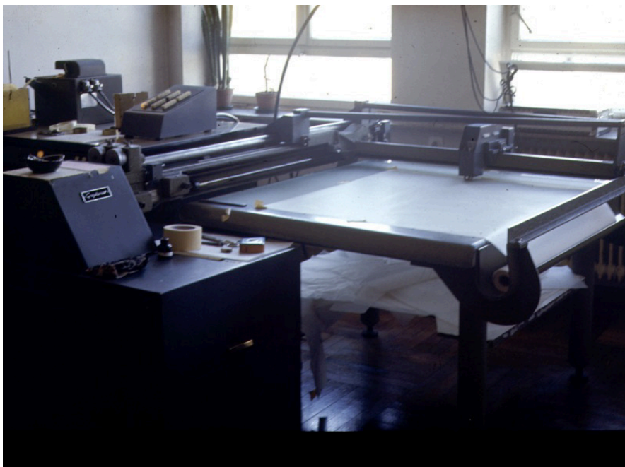
4 ZUSE Z 64 Graphomat, Anlage an der Technischen Universität Stuttgart (vermutlich 1965, nicht später als 1966)
