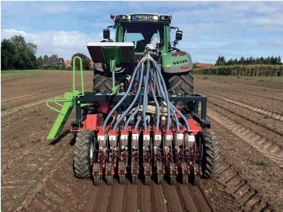
**Abb. 4.** Prototyp einer Sämaschine zur Gleichstandsaat. Zwei-balkiger Aufbau für einen engen Reihenabstand von 7,6 cm und präziser Tiefenführung für optimale Aussaatbedingungen. Foto: Herrmann/JKI.
