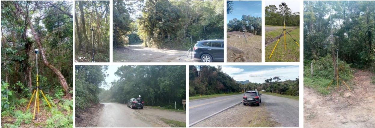
Figura 2 - Exemplos de pontos levantados diretamente em campo com receptores GNSS.
