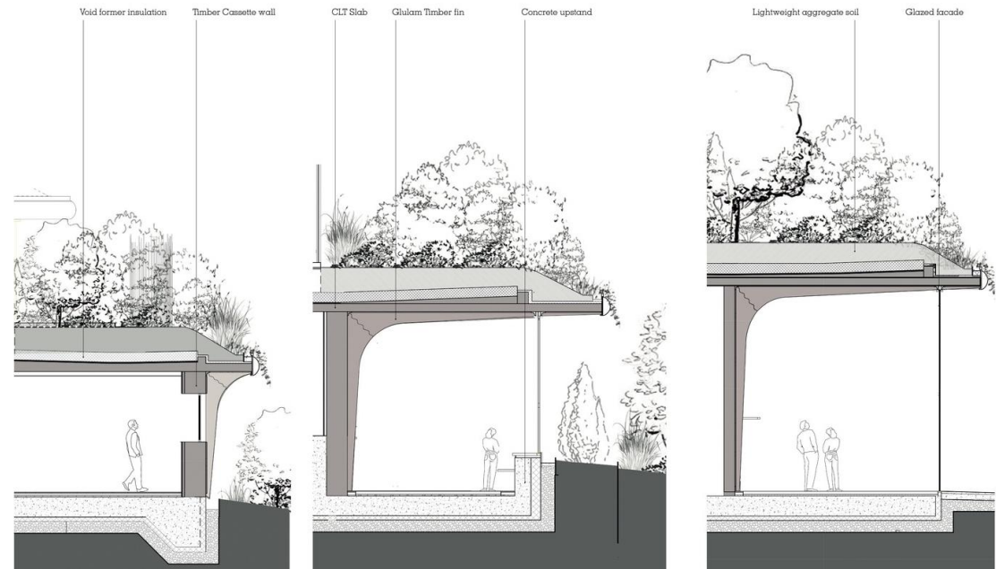
Figura 79. Secciones de los diferentes bloques que muestran la variación de alturas en función de la tipología del espacio.
