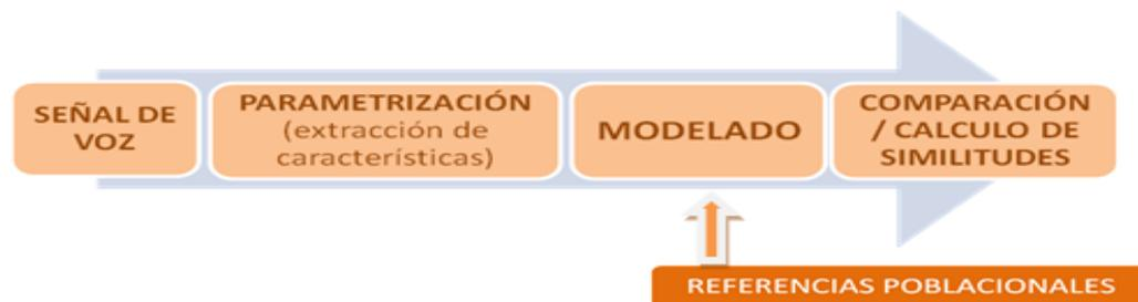
**Figura 12. Esquema general de un Sistema de Reconocimiento Automático de Locutores.**
