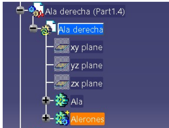
Figura 4.71 Árbol del .CATPart correspondiente al ala con el Body de los alerones.
