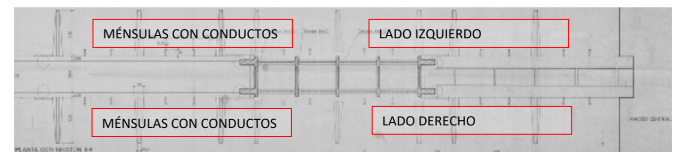
Ilustración 11 Planta de pasarela de acceso con definición de ubicación de tuberías (Fuente: elaboración propia)
