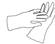
- PARA TRABAJOS ELECTRICOS EN UTILIZACION DIRECTA SOBRE INSTALACIONES DE HASTA 5.000 V GUANTES AISLANTES DE ELECTRICIDAD CLASE II
