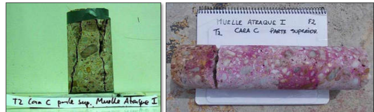
Ilustración 10: Ensayo de resistencia a compresión y carbonatación de testigo de Atraque I (T2)
