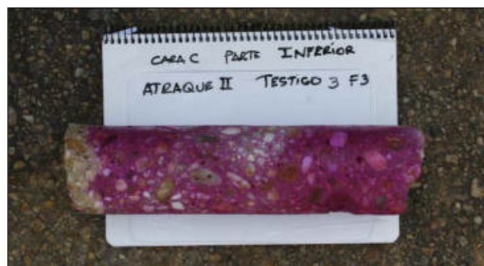
Ilustración 13: Test de fenoltaleína en la determinación de la alcalinidad del hormigón
