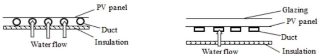
Figura 13. Esquema de una placa plana PVT de tipo agua
