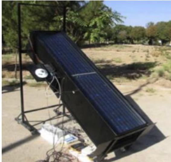
**Figura 32. Fotografía de la instalación experimental del colector de aire PV T estudiado en la Universidad Shahid Bahonar de Kerman**
