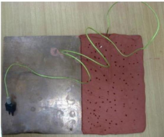
Figura 24. Construcción del elemento de enfriamiento, lámina de cobre con arcilla.
