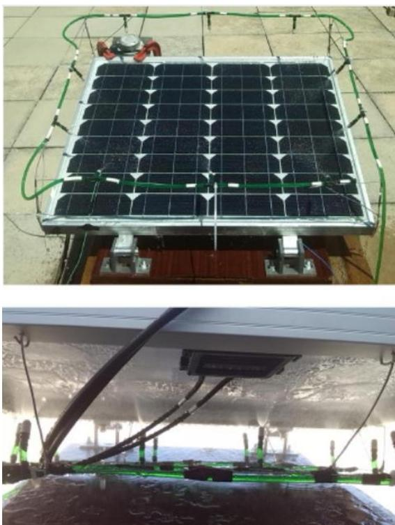
**Figura 22. La parte delantera y trasera del panel fotovoltaico con el sistema de aspersión de agua específico**
