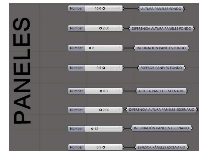
Figura 69_Parámetros establecidos en Grasshopper para definir la geometría de los paneles acústicos.
