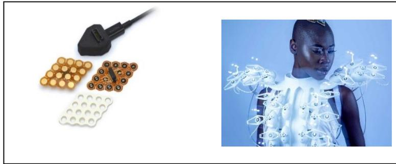
Figura 1-9. El BCI de g.Pangolin utiliza rejillas de electrodos de 16 canales que se montan con una tira adhesiva en la piel humana después de que se llena con gel de electrodo conductor. Esto fue utilizado con fines artísticos para controlar un vestido interactivo. Fuente: [26]- [27].
