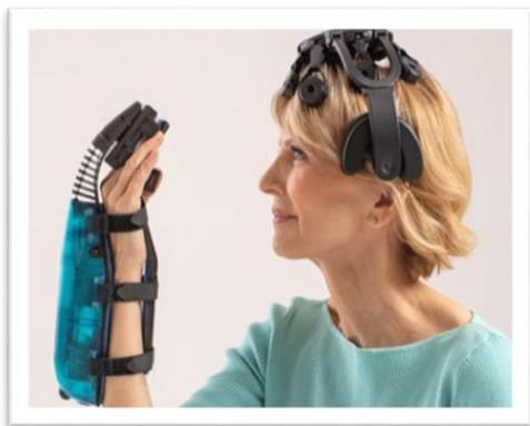
Figura 1-4. El dispositivo consta de un casco que registra señal de EEG y de un exoesqueleto con forma de guante que se sitúa sobre la mano del paciente que se va a rehabilitar. El casco graba señal de EEG del lado del cerebro no dañado por el ictus, y lo envía a un guante robótico que asiste al usuario en los movimientos de la mano. Mediante una Tablet se controla la sesión de rehabilitación, y se guía al paciente en los ejercicios a realizar. Fuente: [238].
