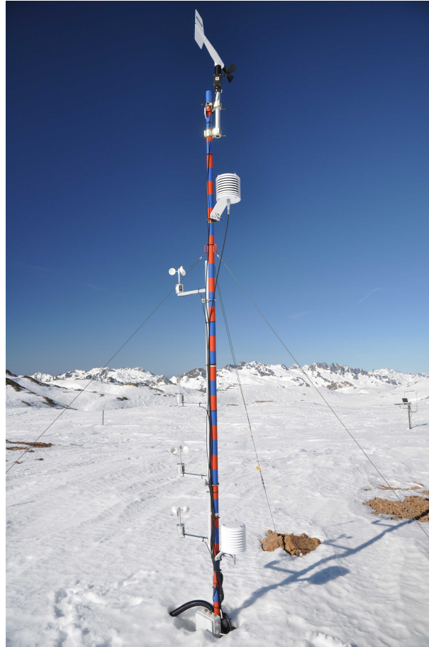
FIGURE 4.4 – Mât de mesures météorologiques déployé au Col du Lac Blanc (Campagne 2012). Les capteurs utilisés sont détaillés dans le tableau 4.1. (Photo : S. Blein)
