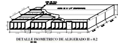
DETALLE ISOMETRICO DE ALIGERADO H = 0.2
