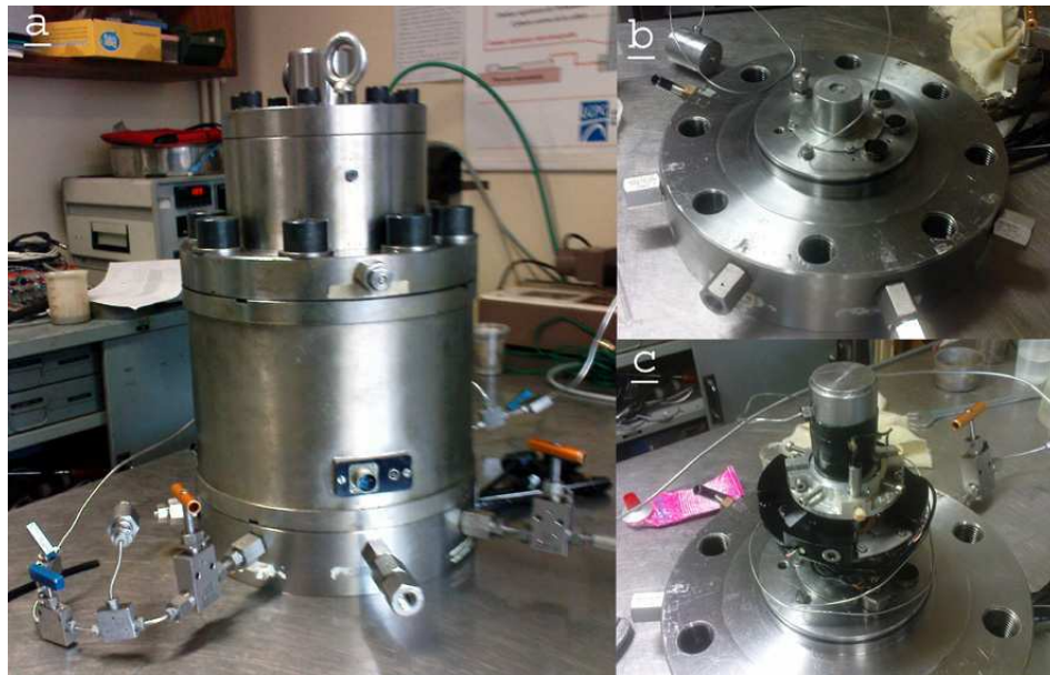
Figure 77: Vue de l'extérieur de la cellule triaxiale ; (b) La partie inférieure de la cellule ; (c) Vue d'un échantillon avec l'installation de l'instrumentation pour les mesures de déplacement (Ghabezloo et al., 2008)
