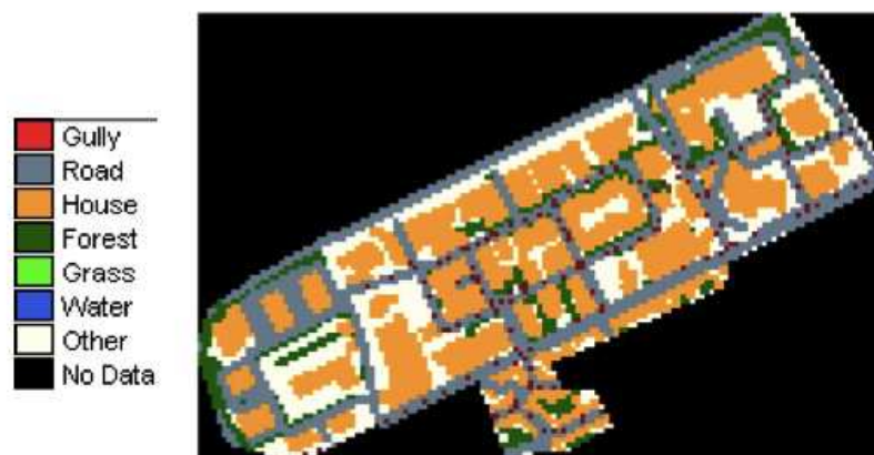
FIGURE 3.43 – Utilisation du sol pour le bassin versant du Loup avec une résolution de 10m (Abbes (2013)).
