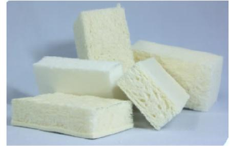
*Figure 5 : Blocs de mousses de cellulose thermo isolants*
