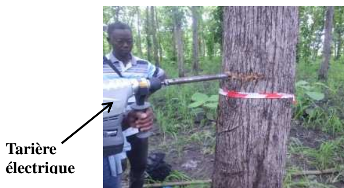
Photo 1: Prélèvement d'une carotte de bois sur un APC
