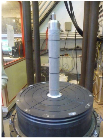
a – mise en place de la crépine
