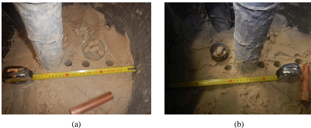
Figure 3-42 – Photos des zones de prélèvements : (a) carottages sur différents rayons ; (b) carottages symétriques par rapport à l'axe de la crépine
