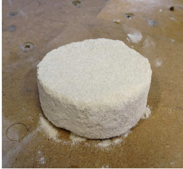
Figure 3-19 – Echantillon prélevé en bas de l'éprouvette pour évaluer sa distribution de la taille d'accès aux pores (essai NE4 ; NE34, d_p = 12 \mu\text{m} , C = 1 \text{ g/l} , Q = 1,4 \text{ cm}^3/\text{s} )
