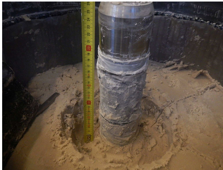
Figure 3-41 – Photo montrant l'emplacement des prélèvements annulaires de sable autour de la crépine
