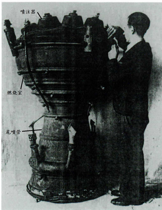
图 1 A-4 (即 V-2) 火箭发动机
