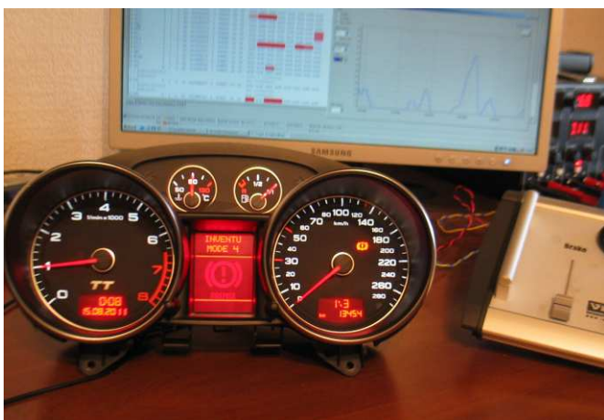
A járműszimulátor HMI laboratóriumi tesztje
