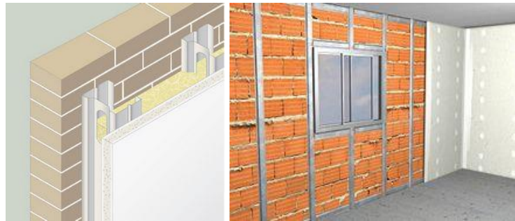
Figura 27 Muro trasdosado a muro perimétrico de ladrillo
