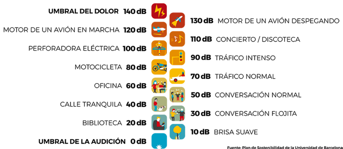
Figura 23 Ruido generado por actividades
