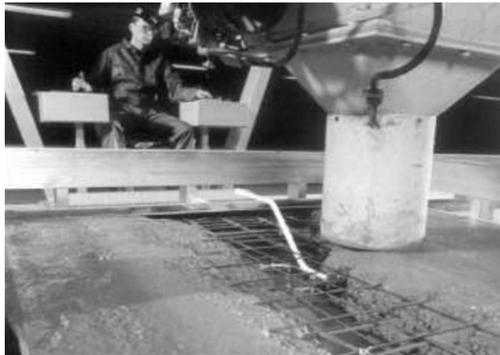
*Figura 4: Manera detallada de vaciado de concreto en una planta de prefabricados.*
