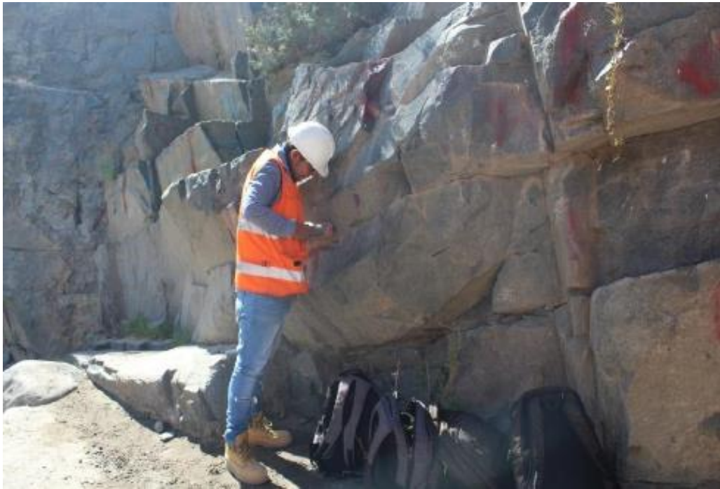
Figura 21. Ensayo con el esclerómetro o martillo de Schmidt. Fuente: Elaboración propia.
