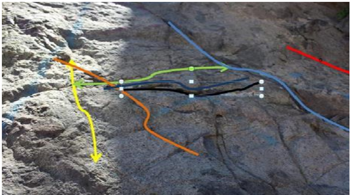
Figura 17. Familias de fracturas y juntas del macizo. Fuente: Elaboración propia. Nota: Ventana de 1 metro.
