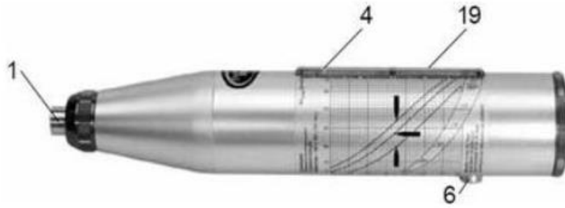
Figura 3. Martillo de Schmidt para ensayo. Fuente: Antonio Lozano, 2004.
