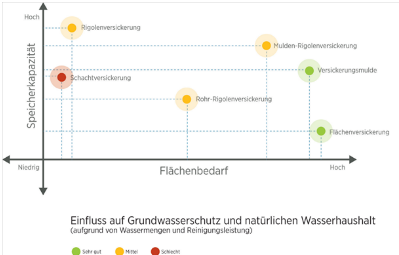
Abbildung 11: Darstellung der Speicherkapazität gegenüber dem Flächenbedarf von unterschiedlichen Maßnahmen zur wassersensiblen Stadtentwicklung sowie eine Bewertung des Einflusses auf Grundwasserschutz und natürlichen Wasserhaushalt; Helming, 2018.
