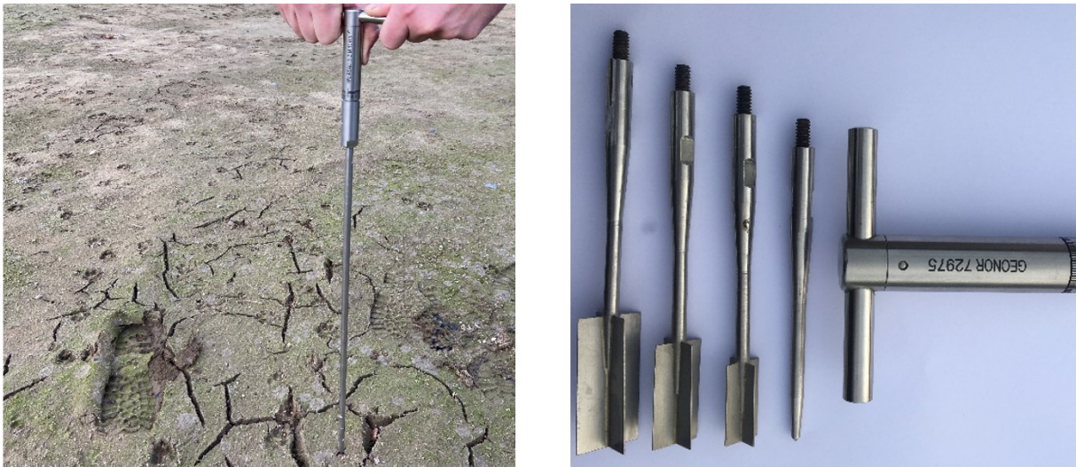
Abbildung 6: Messtechnik zur Ermittlung der Scherfestigkeit
