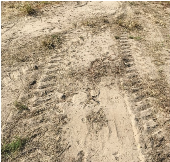
Abbildung 9: Vergleich der Fahrspurenbildung bei unterschiedlicher Scherfestigkeit des Bodens (links MP 2 hohe Scherfestigkeit, rechts MP 4 mittlere Scherfestigkeit)
