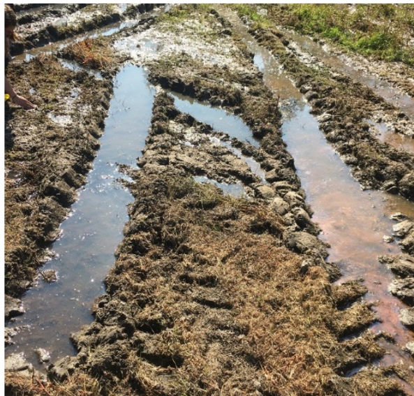
Abbildung 9: Vergleich der Fahrspurenbildung bei unterschiedlicher Scherfestigkeit des Bodens (links MP 2 hohe Scherfestigkeit, rechts MP 4 mittlere Scherfestigkeit)
