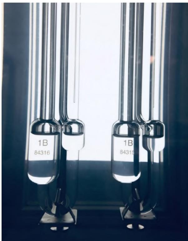
Рис. 7. Полиальфаолефиновое масло, помещенное в капиллярном стеклянном вискозиметре в термостатическую ванну при температуре  $-30\text{ }^{\circ}\text{C}$
