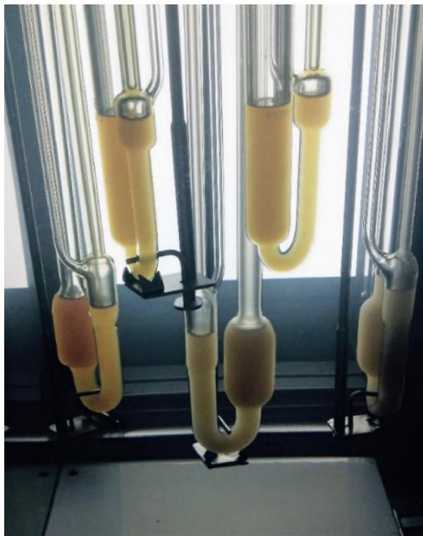
Рис. 6. Моторные масла, помещенные в капиллярном стеклянном вискозиметре в термостатическую ванну при температуре  $-30 \text{ } ^\circ\text{C}$
