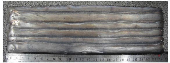
รูปที่ 3 ตัวอย่างชิ้นงานที่ผ่านการเชื่อมพอกแข็ง
