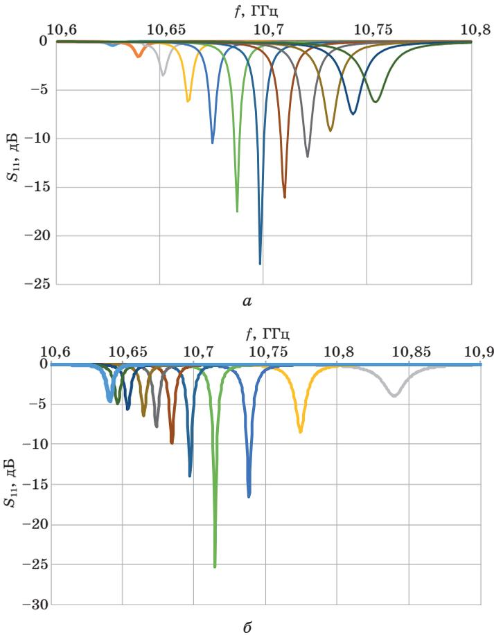
**Рис. 2.**  $S_{11}$  резонаторов с зазором от 60 мкм справа до 5 мкм слева с шагом 5 мкм при толщине стенки 2,25 мм (а) и толщиной стенки от 1 мм справа до 6 мм слева с шагом 0,5 мм при зазоре 30 мкм (б)
