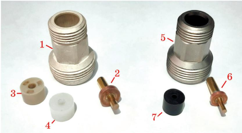
**Рис. 6.** Внешний вид измеряемых шайб и резонаторов:
