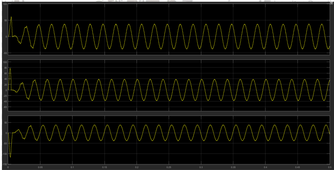
Gambar 4. 11 Gelombang arus sistem dengan SAPF pada beban non-linier R=10Ω dan L=200mH
