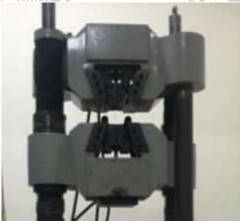
Gambar 2.4 Uji Kuat Tarik Baja Canai Dingin
