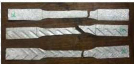
Gambar 2.5 Sampel Baja Canai Dingin
