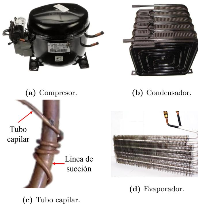
**Figura 3.3.** Componentes principales del sistema de refrigeración.
