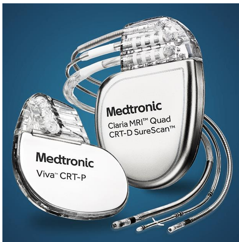
Figura 2 – Dispositivos utilizados na TRC. (CRT-D = implantable cardiac resynchronization therapy defibrillator ; CRT-P = implantable cardiac resynchronization therapy pacemaker ). Retirado de (62)
