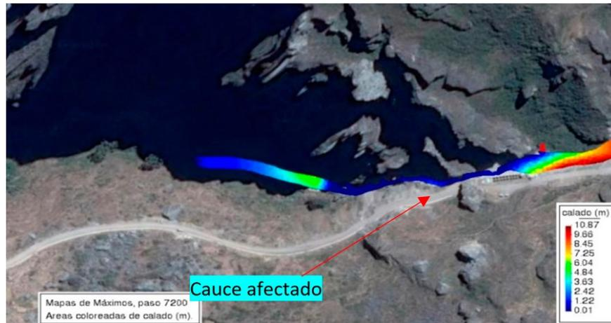
Figura 5. Primeros resultados del software IBER, no se observa desbordamientos del caudal simulado por factores físicos en la cuenca
