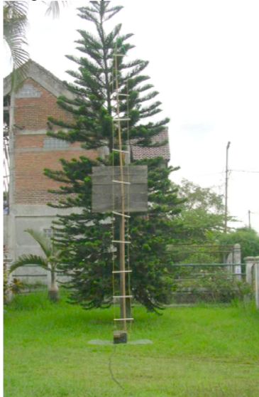
Gambar 7 Antena dengan Tuner dan kabel Coaxial.
