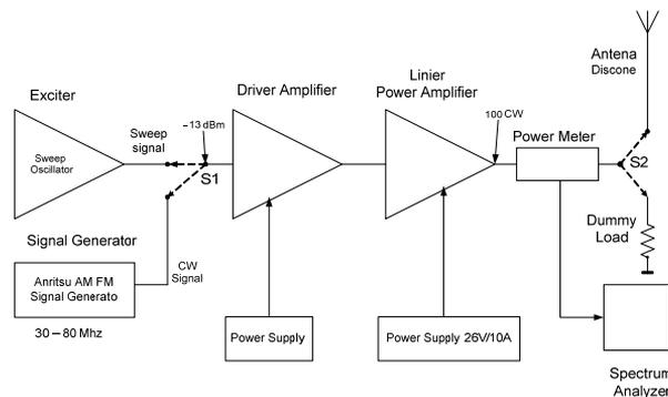
Gambar 6. Blok diagram pengukuran Power Amplifier[2]
