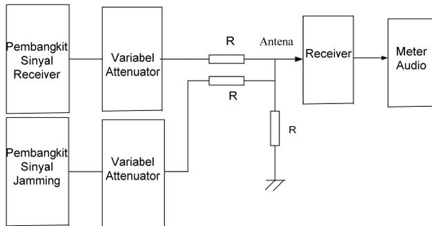
**Gambar 7. Percobaan pengukuran perbandingan sinyal receiver dan sinyal jamming.**
