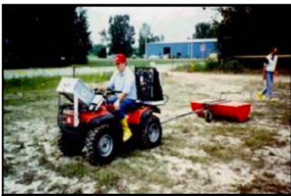
Gambar 2 Antena GPR diderek oleh ATV
