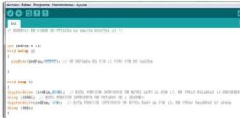
Uno de los primeros programas que se ejecuta en la placa de Arduino es el del led que parpadea. Este es un programa sencillo, cuyo objetivo es encender y apagar la luz del led. El parpadeo de un led, es el Hello World de los microcontroladores. La sigla LED significa Diodo Emisor de Luz (En inglés: Light Emitting Diode)
