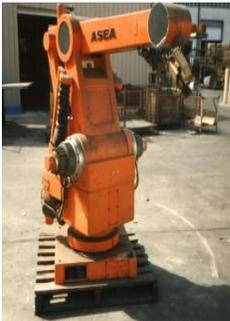
En 1973, ASEA construyó el IRb6, el primer robot con accionamiento totalmente eléctrico.
