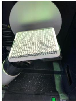
**Figura 5:** Imagem representativa da placa de calibração do scanner Arti600, ZirkohnZahn.
